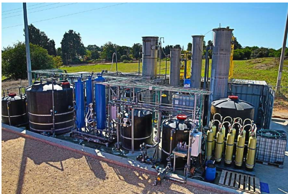
איור 7 : מתקן הדגמה לטיפול ביולוגי במגוון מזהמים (פכרלורט, כלוראט, חומרי נפץ, ניטראט וכרום) במתחם התעש ברמת השרון.
