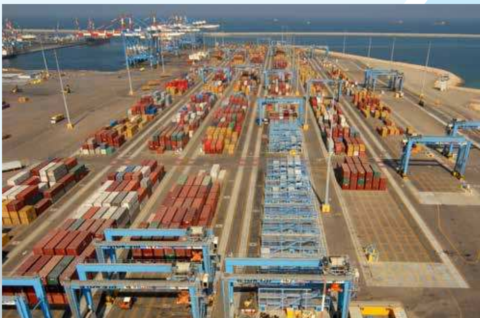
מנוף RTG- Rubber Tired Gantry Crane הינו מנוף הנוסע על גלגלים, המסוגל לנוע בערוגות מכולות ולעבור מערוגה לערוגה ע"י הטיית הגלגלים ב-90 מעלות.
