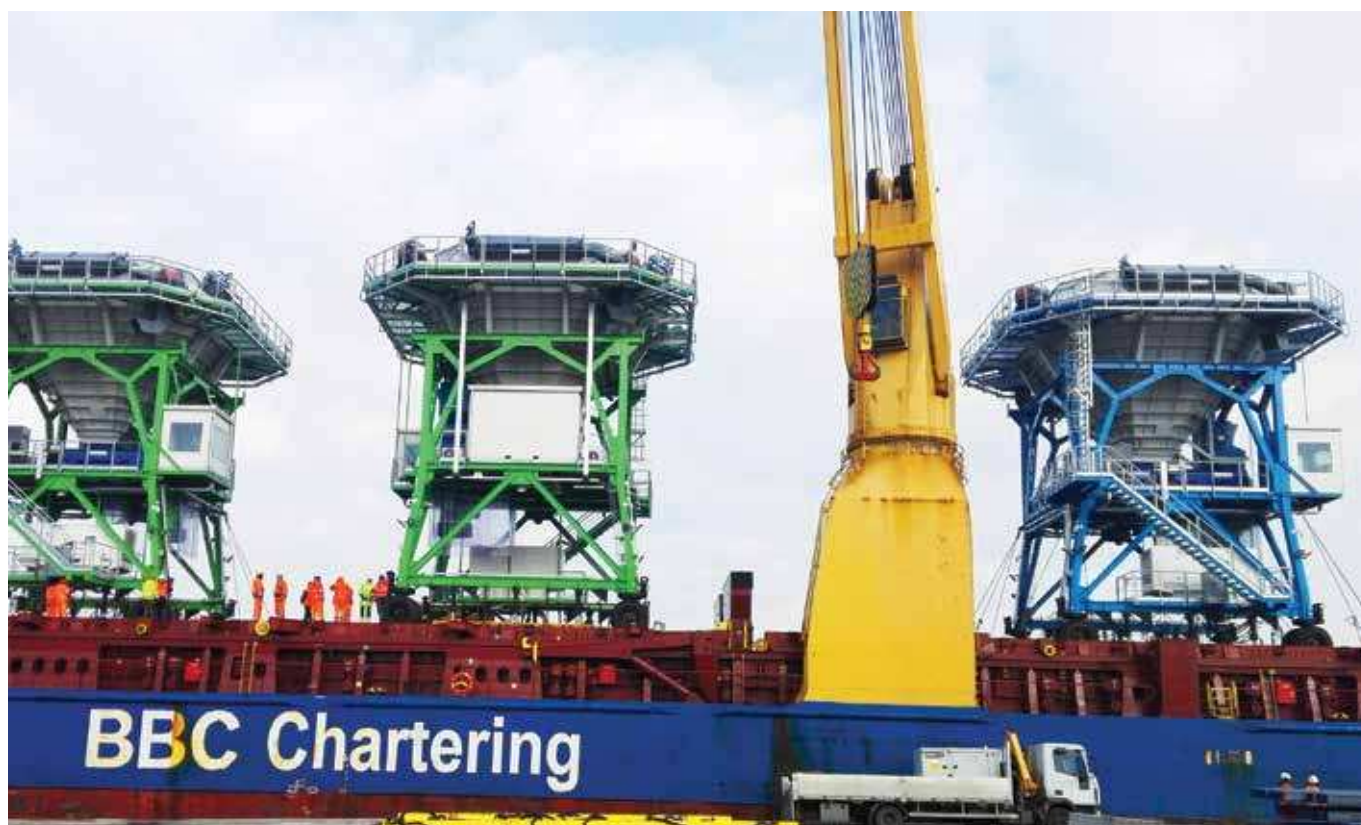
בתמונה: משפכים ירוקים המשמשים לפריקת קלינקר (מימין) ותבואות (משמאל)
